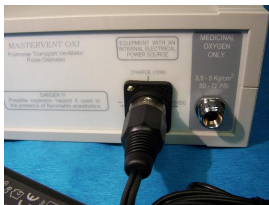
Conexión de alimentación de 12Vcc
