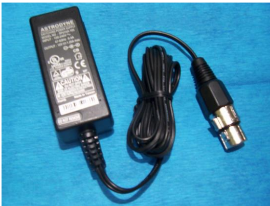
Fuente switching externa para carga de batería
