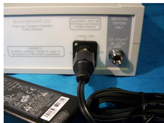
Conexión de cargador de batería
